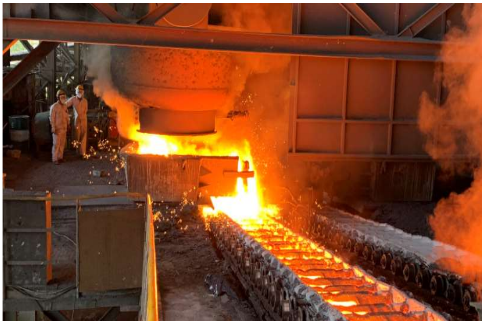
Ingot casting of NPI.
